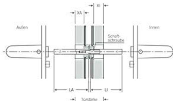
Für Schlösser mit geteilter Nuss steht ein geprüfter und nach DIN 18 273 zugelassener FSB-Spezialstift (Vierkant 9 mm) mit der Bestellnummer 05 0125 zur Verfügung, mit dem – bei einem mittig sitzenden Schloss – Türstärken von 34 bis 101 mm überbrückt werden können.
